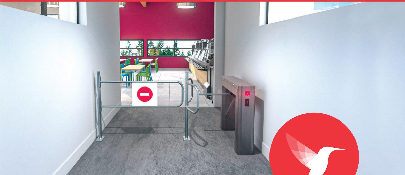
Exemple d'installation d'un tourniquet assurant 20 passages / minute associé à un portillon PMR avec sens d'ouverture poussant à 90°.
